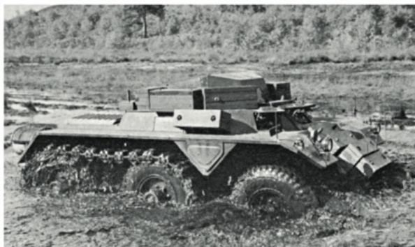
Een Saladin prototype. Tijdens test werd ook de waterdoorwading getest.
