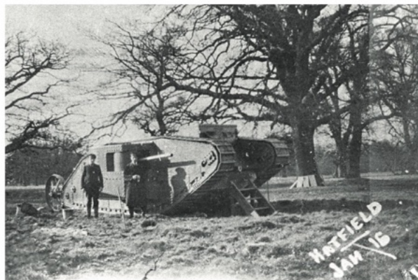
▲ "Mother" (moeder alle tanks) wordt getest in Hattfield, Engeland, Januari 1916. Eigenlijk zien we hier in basis een "Little Willie" romp geklemd tussen de twee grote rupsbanden. Om geen wapens op het hoge dak te hebben, werden twee "huisjes" aan de zijkanten aangebracht met twee kanonnen (Male) of vier machinegeweren (Female).
